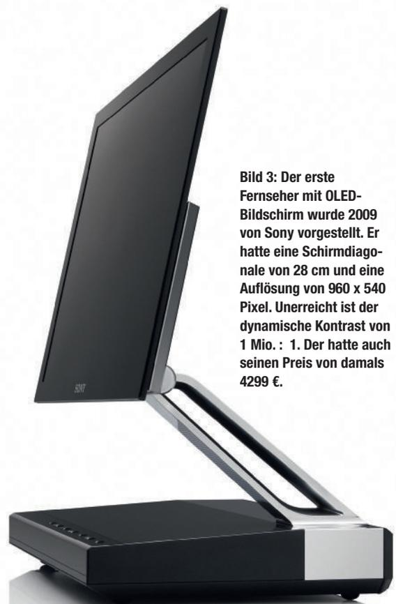
**Bild 3: Der erste Fernseher mit OLED-Bildschirm wurde 2009 von Sony vorgestellt. Er hatte eine Schirmdiagonale von 28 cm und eine Auflösung von 960 x 540 Pixel. Unerreicht ist der dynamische Kontrast von 1 Mio. : 1. Der hatte auch seinen Preis von damals 4299 €.**
